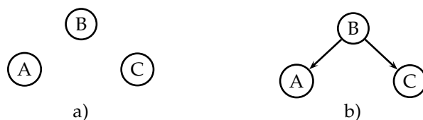
Obrázek 5.4: Dva modely Bayesovských sítí reprezentující závislosti jevů A, B, C : a) nezávislost, b) závislost B \rightarrow A a B \rightarrow C
